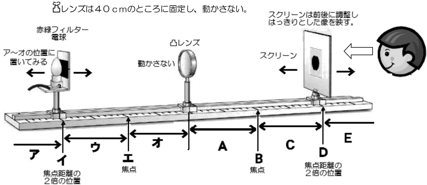
② スクリーンをセットして、光源をアの位置に置いたとき、スクリーンだけを前後に動かして、はっきりした像をスクリーンに映し、スクリーンの後方から観察し、次のことを調べる。
